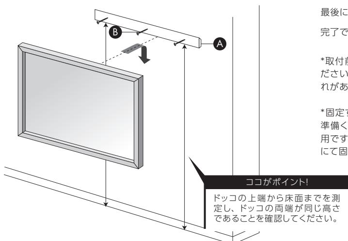
別売りのミラーを設置したい場所を目安に A ドッコを壁に当て、プラスドライバー(または電動ドライバー)を使い、B ビスを打ちます。
