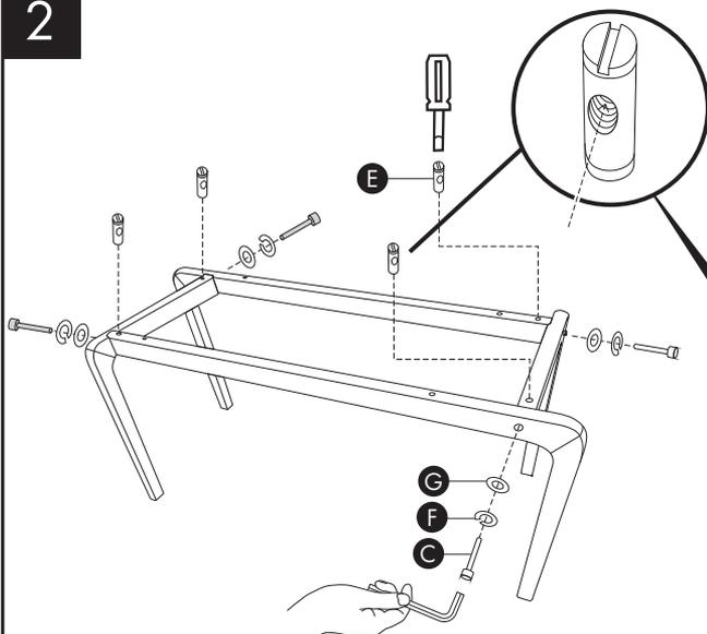
**E** ナットをはめ込み、マイナスドライバーで穴の向きを調整しながら、**C** ボルトに、**F** スプリングワッシャーと **G** ワッシャーを差し込んで、軽く締めます。
