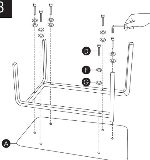
**A** 天板を裏返し、組み上げた脚のをせ、**D** ボルトに **F** スプリングワッシャーと **G** ワッシャーを差し込み1本ずつ軽く締めます。
