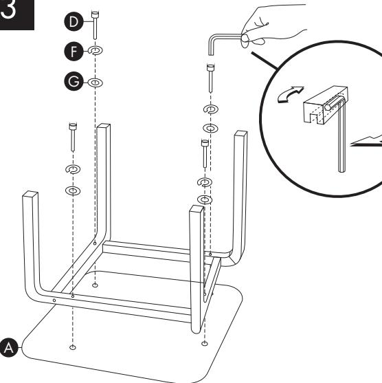
A 座面を裏返し、組み上げた脚をのせ、D ボルトに F スプリングワッシャーと G ワッシャーを差し込み1本ずつ軽く締めます。
